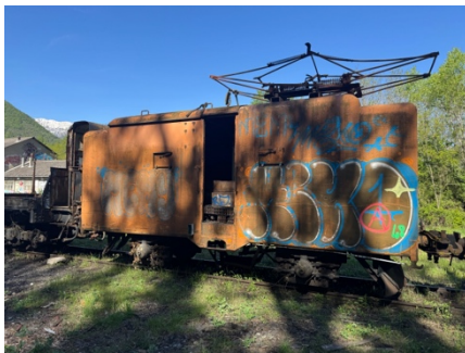
3 - Le locotracteur présent, aux parois en béton et attendant sa restauration à venir.
